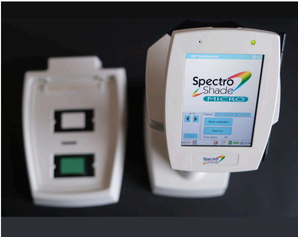
Şekil 3. Renk ölçümünde kullanılacak spektrofotometre cihazı (SpektoShade, MHT Optic Research, Niederhasli, İsviçre)
